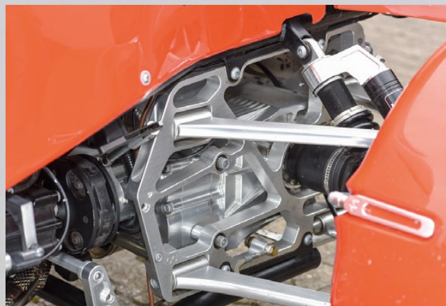
Schweizer Präzision: Die Frästeile der Radaufhängungen, hier am Hinterrad-Differenzial, stammen vom Schweizer Quadbauer Grüter und Gut
