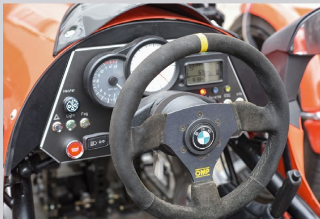
Originale BMW K1300-Instrumente. Was nicht adäquat als Automobil-Rennsportzubehör zu haben war, wurde selbst gebaut
