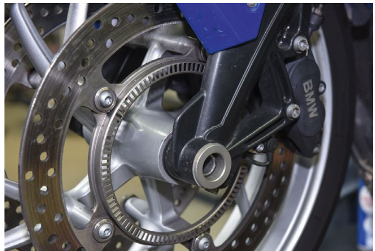
Frühere Raddrehzahlgeber im Vorderrad mit 100 Lochungen, 78 waren es im Hinterradantrieb. Bei modernen ABS-Systemen sind jeweils 48 Lochungen Standard
