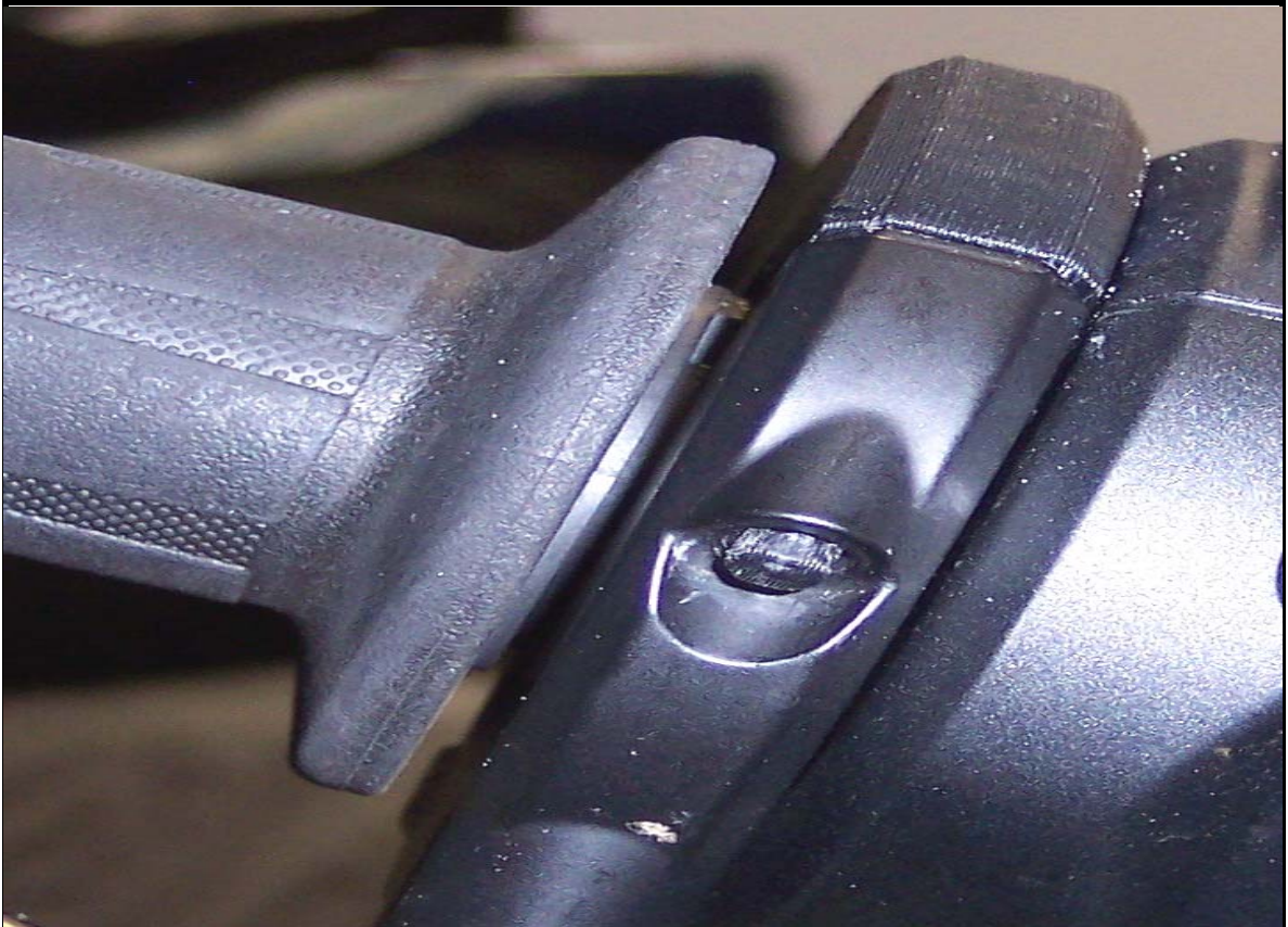
Halbschale vollständig aufdrücken bis Clips vorne aus dem Gehäuse ragt.
