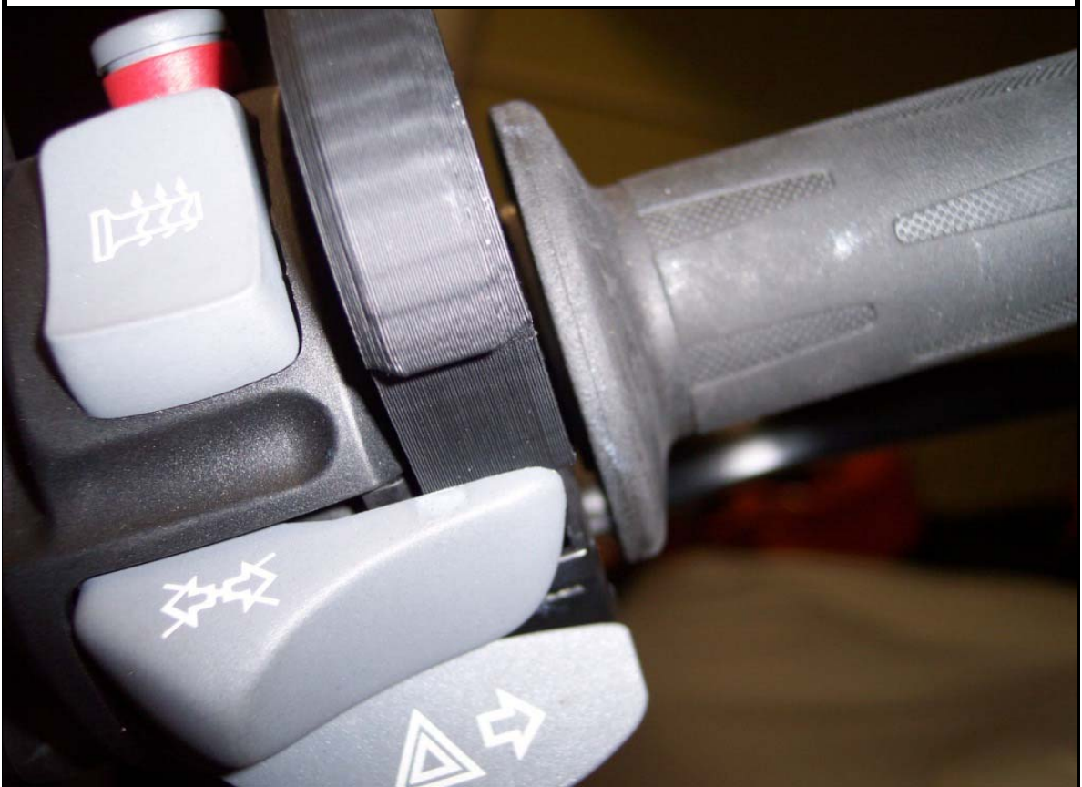
Halbschale hinten bis kurz unter den Blinkerschalter stecken.
